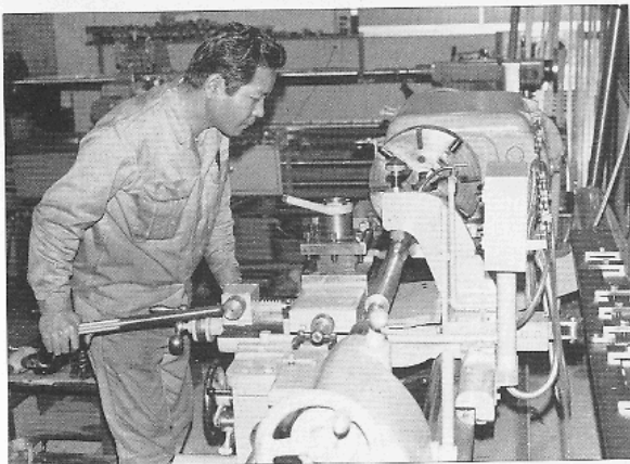
普通の旋盤に自家性の制御機器（右端）を取り付けたアイデア旋盤。
